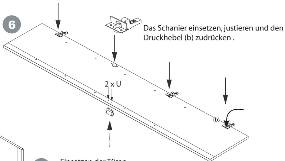
Das Schanier einsetzen, justieren und den Druckhebel (b) zudrücken .
